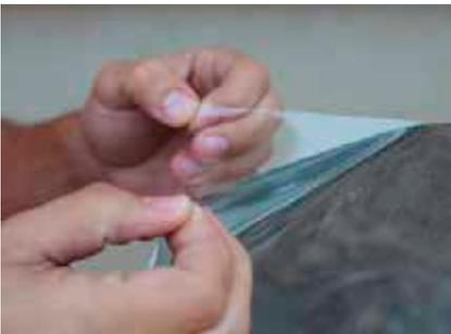
Das Papierklebeband benutzen, um den Liner in einer der oberen Ecken von der Folie zu trennen. Dazu die Finger befeuchten – NIEMALS mit trockenen Fingern die Klebefläche berühren!
